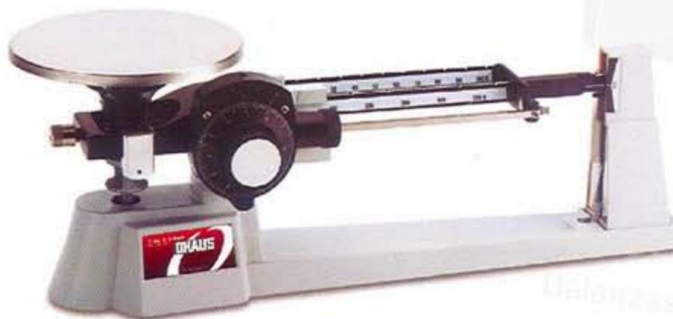
La serie Dial-o-Gram® combina la comodidad de la calibración mediante un dial de lectura directa con la velocidad de la amortiguación magnética para lograr una balanza capaz de pesarlo todo con exactitud y rapidez
